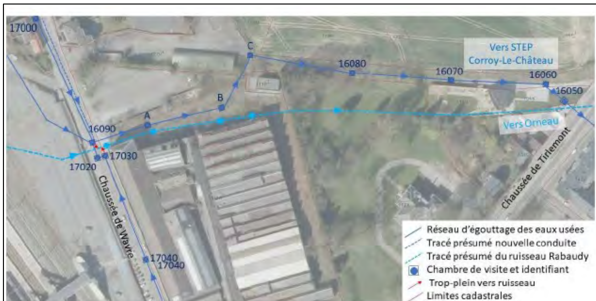
Figure 32 : Localisation des réseaux d'égouttage
