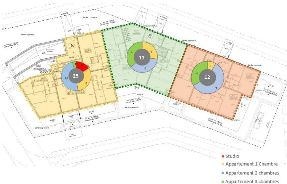
Figure 12 Disposition schématique du logement au sein de l'ensemble 2 du projet (source : Syntaxe architectes, 2021)
