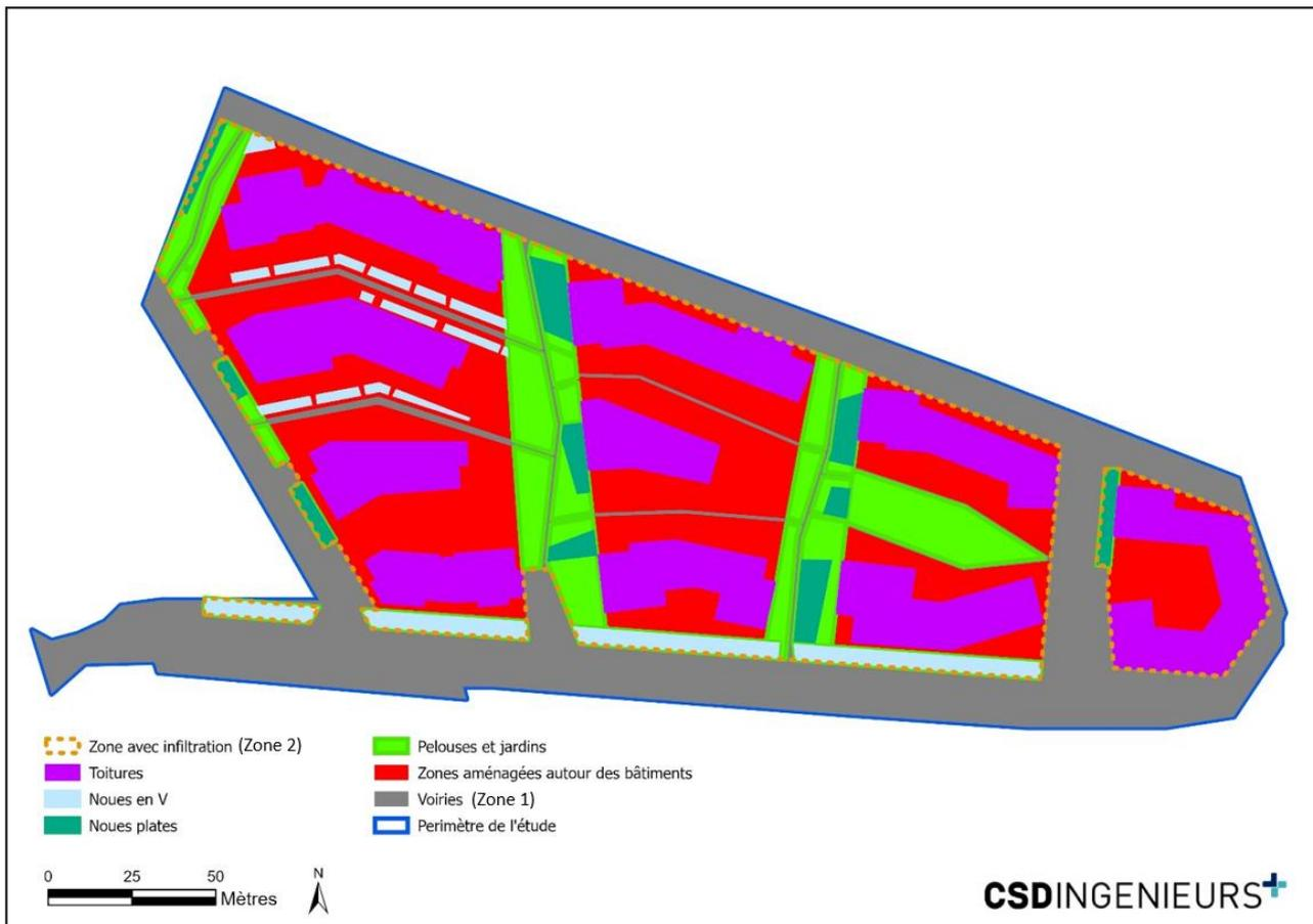
Figure 64 Illustration des différentes zones d'infiltration considérées (source : CSD, 2021)
