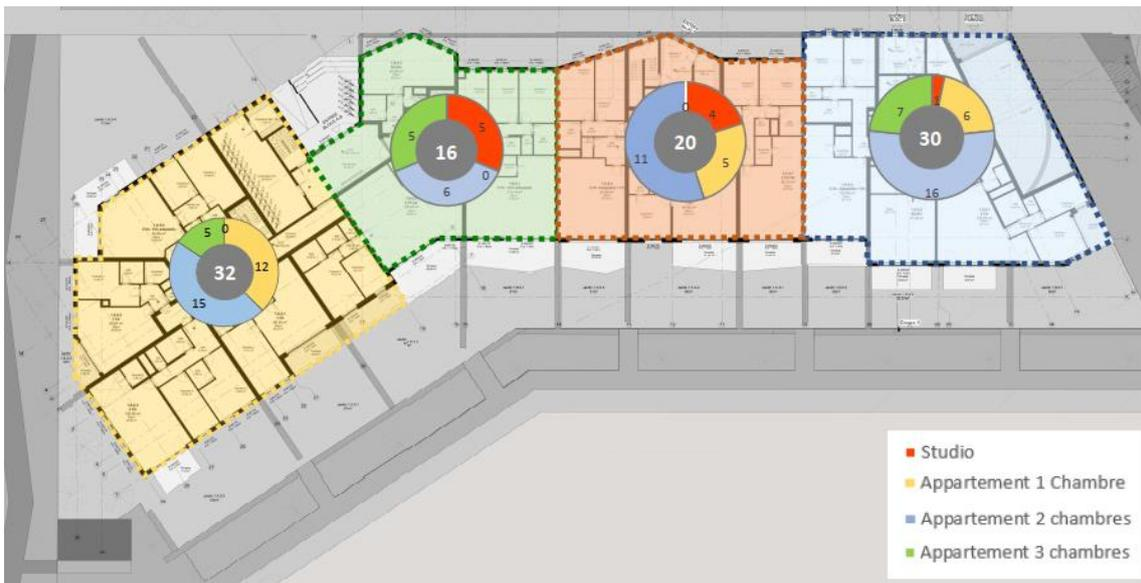
Figure 11 Disposition schématique du logement au sein de l'ensemble 1 du projet (source : Syntaxe architectes, 2021)
