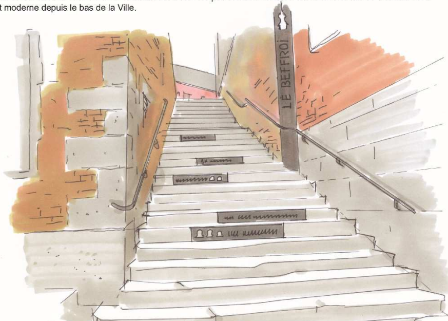
Bandeaux horizontaux de marquage des contremarches du grand escalier
